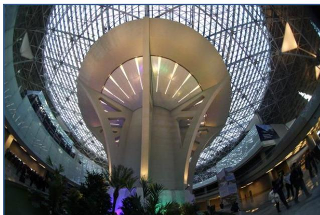
больших залах установлены простые в эксплуатации системы отраженного дневного света, позволяющие с максимальной эффективностью использовать его в светлое время суток. Помимо очевидной экономии электроэнергии, это позволило создать в залах мягкое равномерное освещение, приятное для глаз посетителей. При этом мощность электрической подсветки зависит от уровня естественной освещенности и в большинстве помещений регулируется автоматически.
